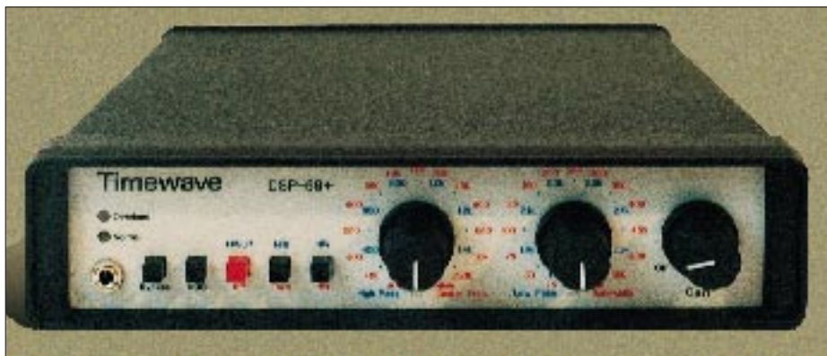
Bild 1: Frontansicht des DSP-59+. V.l.n.r.: die beiden LEDs „Normal“ und „Overload“, darunter der NF-Ausgang mit Klinkenbuchse, daneben die rastenden Drucktasten Bypass, AGC, HP+LP/BP, NRr/Tone, NRr für HP+LP/BP. Der linke Drehschalter bedient den HP, bei BP die Mittenfrequenz, bei „Option“ kann eine programmierte Mittenfrequenz für „Wideband Data“ eingeschaltet werden. Der rechte Drehschalter ist für den LP zuständig, bei BP für die Bandbreite. Rechts der Gain-Steller mit Einschaltknopf.
