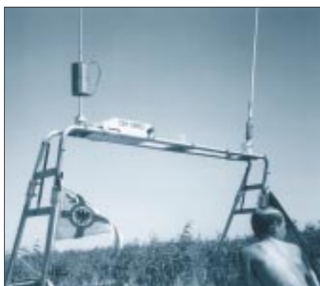
Bild 3: Die Befestigung der KW-Antenne erfolgte auf einem am Heck des Bootes montierten Geräteträger (im Bild links).
